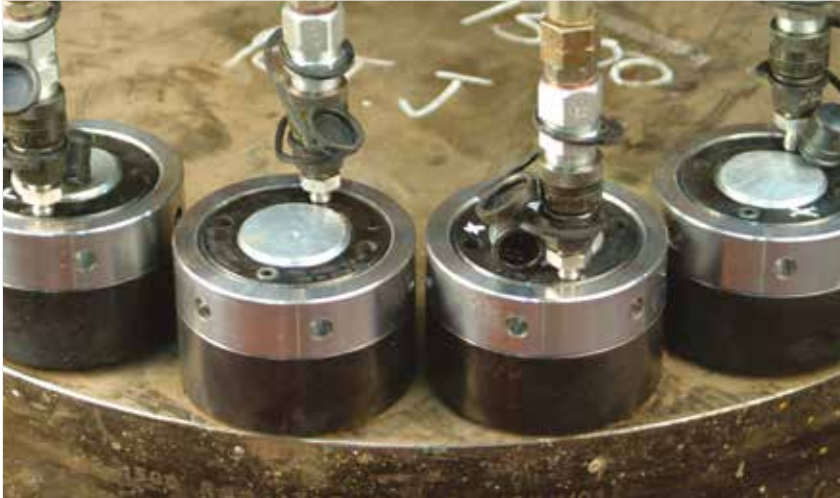
▲ Vorspannen mit Hydraulikmuttern.
