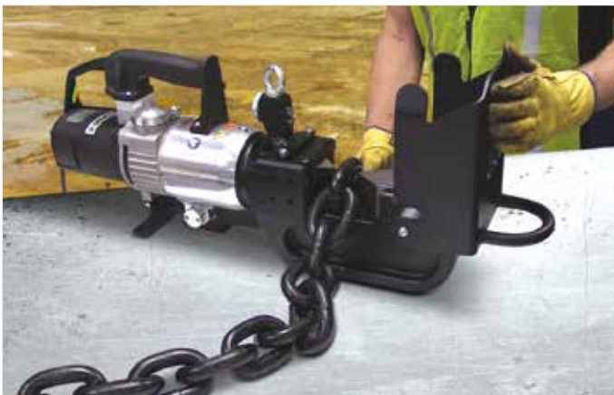
◀ Einfaches Durchtrennen von Kettengliedern mit den Kettenschneidern von Enerpac.
