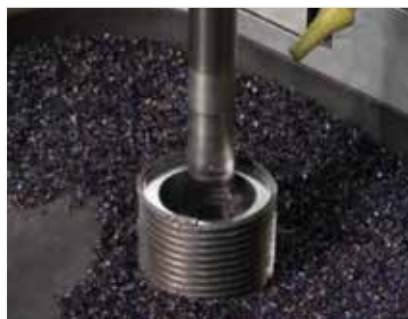
▲ Ausbohren der Mitte eines Bolzens (kleiner Durchmesser).
