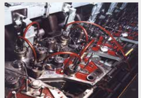
▲ Hydraulikmuttern an einem Dieselmotor.
