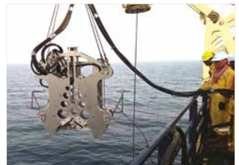
▲ Ins Meer abgesenkte MDWS-Diamantkettensäge.
