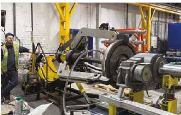
◀ LGH3100 zum Entfernen des Laufrads von der Achse.
