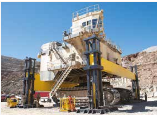
◀ Eine 1200 t schwere elektrische Bergbaumaschine wird mit 500 t Zylindern der RR-Serie und einem Pumpe-pro-Hebepunkt-Synchronhubsystem angehoben.
