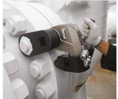
▲ Räätälöity S11000X-momenttiavain räätälöidyllä kiertovivulla ja tukirullalla.
