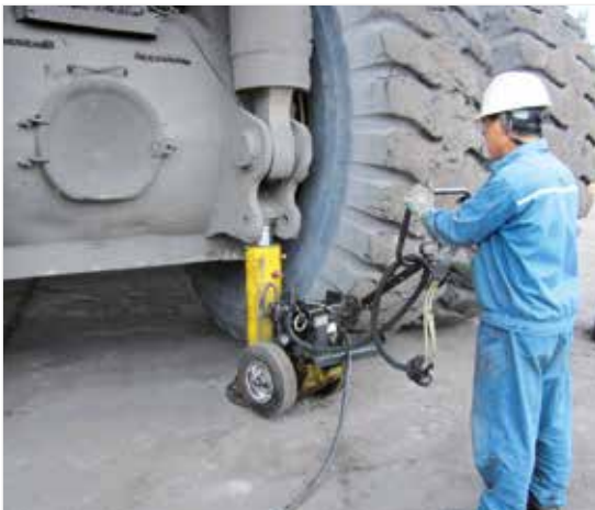
◀ Enerpac POW'R-RISER® nostamassa raskasta kalustoa kaivoksella.
