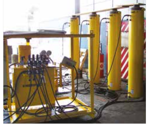
▲ 500 tonnin kaksitoimiset erikoissylinterit 1,83 m:n iskulla kaivinkoneiden nostamiseen.
